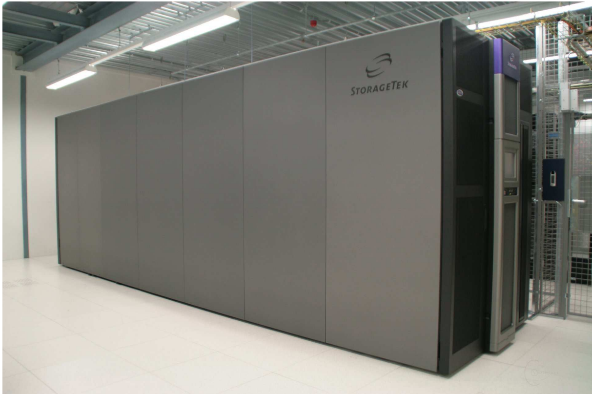
Afbeelding14: tapelibrary van O3 waarin duizenden digitale datatapes zijn opgeslagen. (Bron: foto gemaakt door medewerker van O3).
