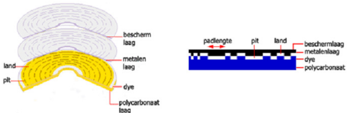
Figuur 1: De samenstelling en structuur van een OGD 13 .
